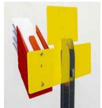
Fixation d'une boîte à lot sur le poteau du module de stockage
