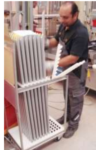
L'opérateur « ferme » les compartiments lorsqu'il remplit au fur et à mesure le Benhur.
