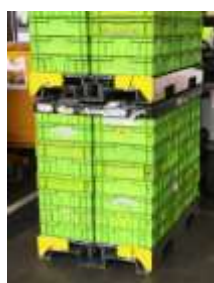
Gerbage de 2 palettes à Rollis avec une coiffe
