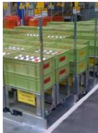
Rollis rehaussé lesté pour pôles de disjoncteur en cuivre L0111
