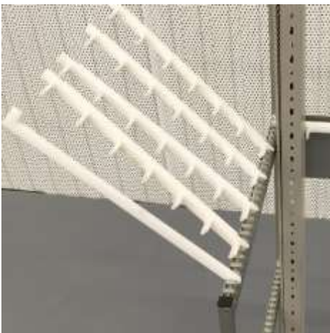
Fixation des séparateurs sur la crémaillère gauche
