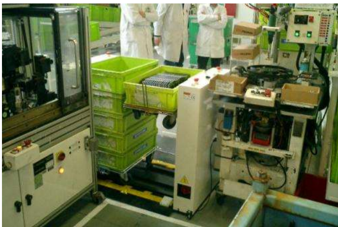
Le retour des bacs vides est extérieur à la ligne et ne rallonge pas le trajet de l'opérateur
