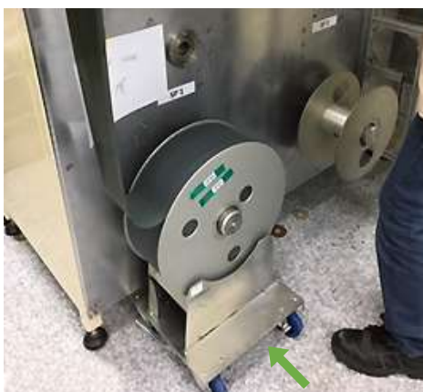
Chargement latéral d'une bobine sur broche
