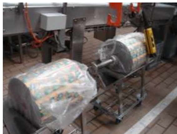
Insertion de l'axe support à hauteur d'homme
