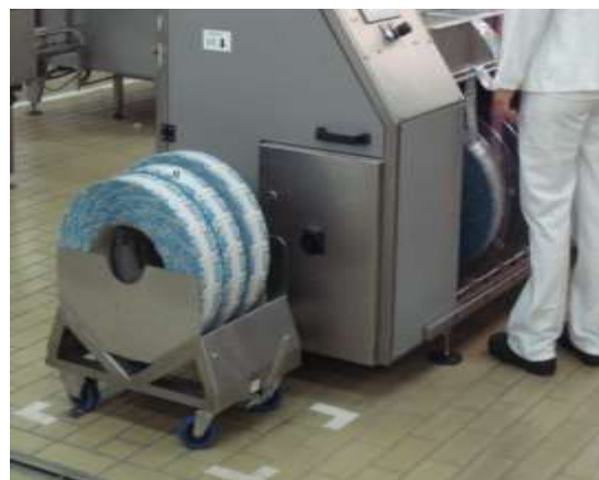
Le Rollis bobine U peut accueillir plusieurs bobines grâce à des compartiments
