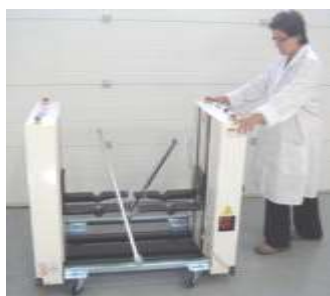
2 béquilles (L0184) pour déplacer le dépileur
