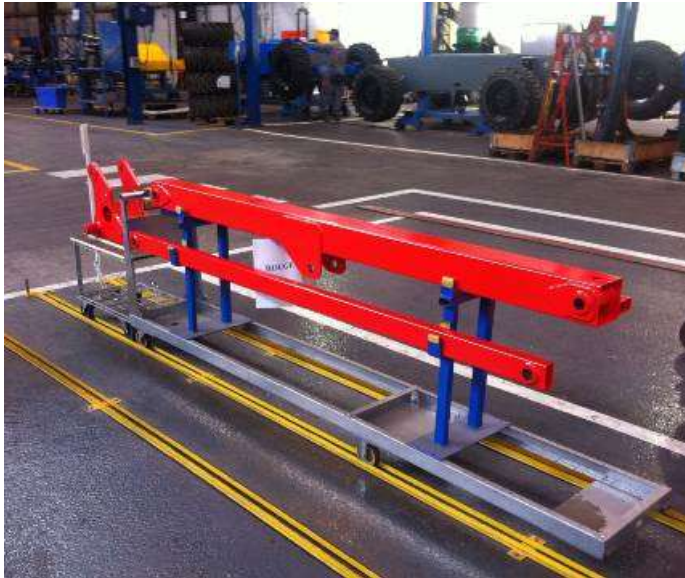
Poutres stockées sur lignes d'assemblage
