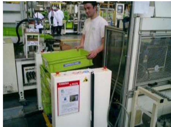
Transfert du bac vide sur la pile adjacente
