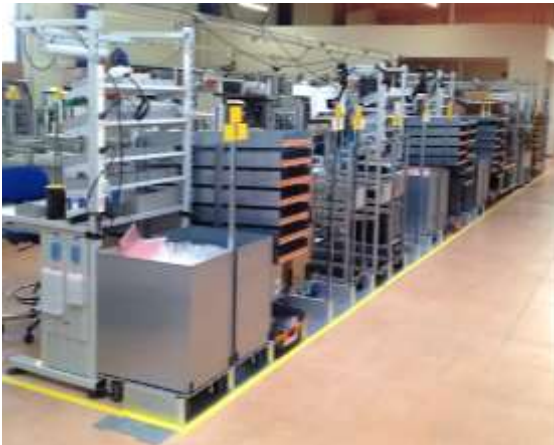
La ligne alterne poste et approvisionnement en bac dans un Rack et pile sur Rollis
