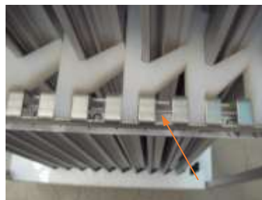
Axe en inox ( L0069 ) inséré dans la crémaillère et traversant les séparateurs
