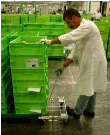
Transfert manuel de la palette sur un Rollis®
