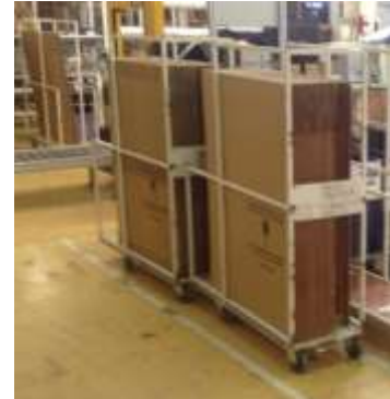
Rollis U lesté pour cartons grande dimension
