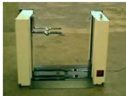
Le dépileur est traversant, on peut aller chercher le Rollis® suivant
