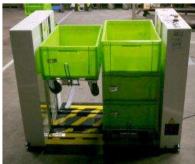
Le dépileur fonctionne avec toutes les hauteurs de bacs (maximum 320). L'ajustement se fait par une vis réglable à la main
