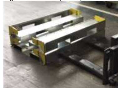
Prise par chariot élévateur des 2 côtés
