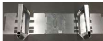
Gabarits de pose pour positionner les plaques au sol des rangées de 600 mm de large
