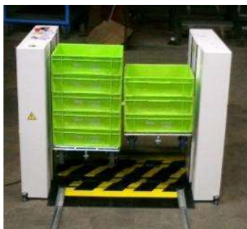
Le dépileur fonctionne avec toutes les hauteurs de bacs (maximum 320). L'ajustement se fait par une vis réglable à la main
