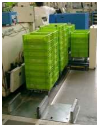
Kit entrée sortie pour approvisionner un dépileur
