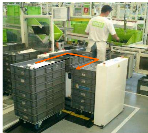
Le dépilleur réduit la surface d'approvisionnement et clarifie l'espace de travail
