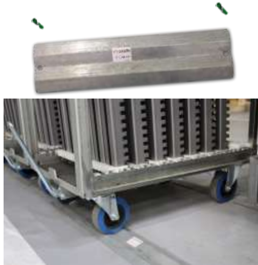
Le positionneur bloque les 2 roues avant
