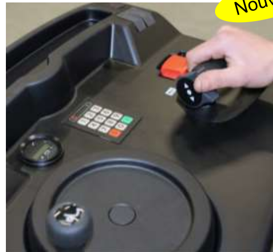
Accélérateur au niveau du tableau de conduite, pour garder les pieds stables sur la machine
