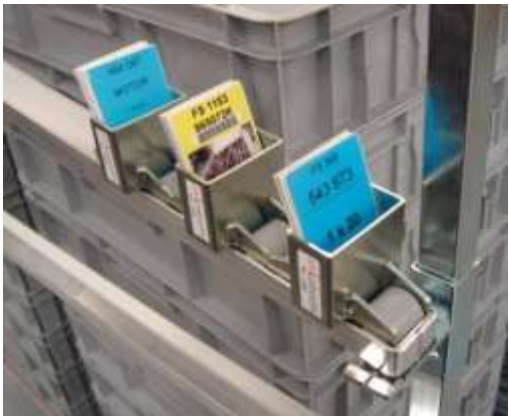
Les cartes arrivent dans le godet face à l'opérateur dans l'ordre de production. Les différentes cartes représentent les références à produire.
