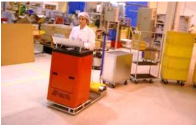
Le pupitre de Kanban se fixe dans les trous supérieurs de l'Ergomover. Pas besoin d'adaptation
