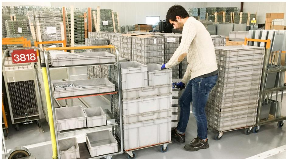
*Produit phare de Labadis, le système Rollis®. Un seul opérateur tire un train articulé de plusieurs centaines de kilos. Chaque wagon est aménagé en fonction de la référence à laquelle il est destiné. Les timons se télescopent au freinage pour former un bloc, chargeable en camion.*
