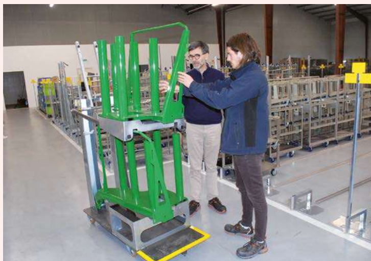
▲ Labadis fabrique notamment le système Rollis®, train articulé de chariots qui remplace la palette et s'adapte à tous les types de marchandises.
