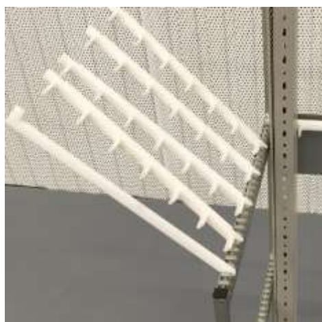
Fixation des séparateurs sur la crémaillère gauche
