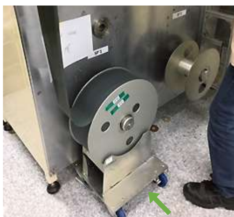
Chargement latéral d'une bobine sur broche
