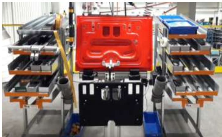
28 pièces sont amenées dans la zone de prise de l'opérateur
