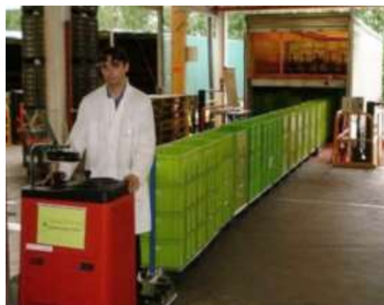
Déchargement de 22 Rollis en une fois
