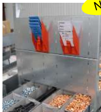
Support pour boîtes à lot sur Rack de stockage (L0542)
