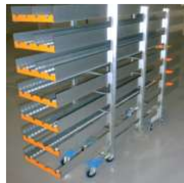
Patinette ( LD0584 ) pour déplacer les racks. Les 4 roues pivotantes permettent le déplacement latéral.
