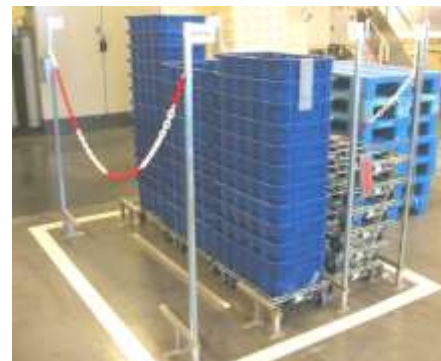
Module de stockage en inox (L0084) ilotés avec des bandes au sol et avec des chaînes plastique
