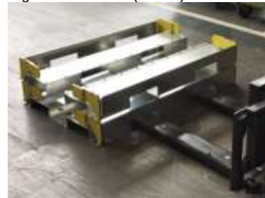
Prise par chariot élévateur des 2 côtés
