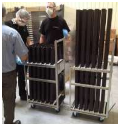
Les peignes protègent la peinture des pièces contre les chocs
