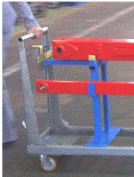
Prise ergonomique pour manipulation à la main
