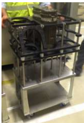
Rollis pour le changement rapide d'outils d'injection
