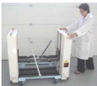
2 béquilles (L0184) pour déplacer le dépileur
