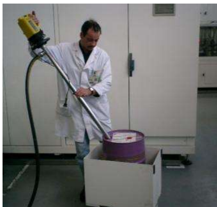
L'introduction des canules se fait sans risque d'éclaboussure au visage
