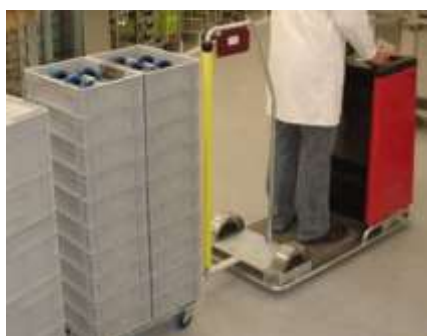
Cavalier maintenant 2 rangées de bacs 400 x 300 sur Rollis
