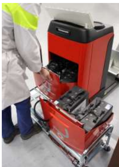
20 secondes pour changer de batterie
