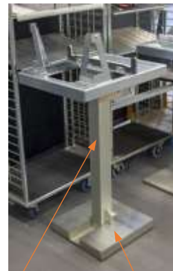
Le posoir (L0547) avec lest (L0288) accueille gabarit de montage et outillages
