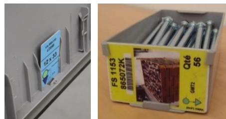
La carte Kanban est logée dans des encoches moulées dans la masse ; sa prise est facile et sans hésitation grâce à son inclinaison
