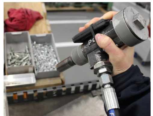
Outil de rivetage modifié : Léger (sans accumulation de queues de rivets) Ergonomique (prise en poignet droit)
