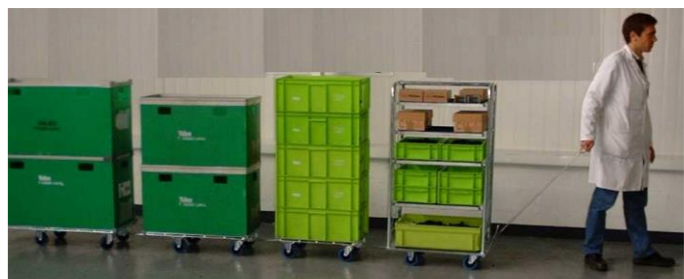
Train de Rollis et servante pour l'approvisionnement d'une ligne
