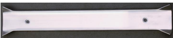
Rail découpé à longueur, prêt à poser : extrémités ouvertes pour un guidage des roues. 2 trous sont chanfreinés pour que la tête de vis ne dépasse pas
