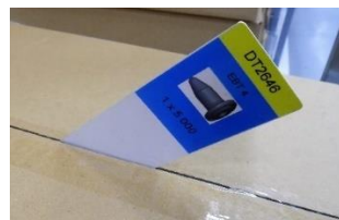
La carte peut s'insérer directement dans les rainures du carton pour identifier son contenu. L'information sur la carte Kanban est toujours visible.
