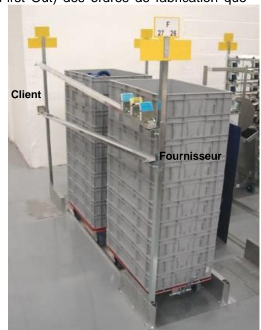
Rail de lancement ( L0196 ) fixé par 2 pattes ( L0195 ) sur les poteaux des modules de stockage
