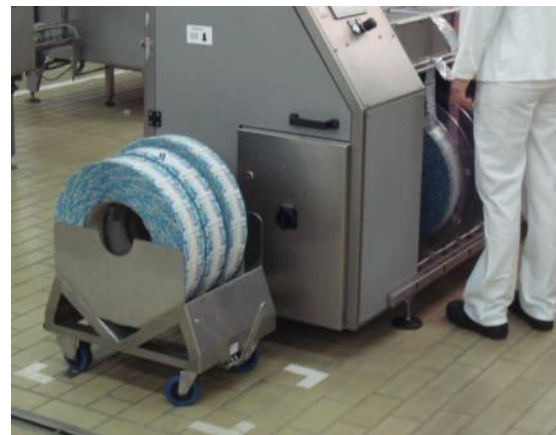
Le Rollis bobine U peut accueillir plusieurs bobines grâce à des compartiments
