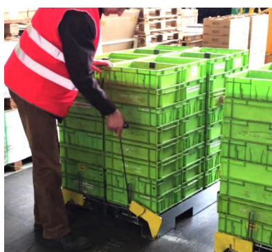
L'ouverture des loquets de verrouillage se fait sans se baisser
