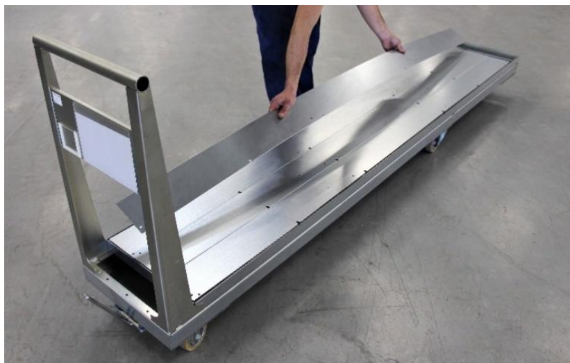
Rollis transatlantic de 2 400 mm utilisé comme navette pour le transport de tôles
