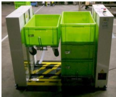
Le dépileur fonctionne avec toutes les hauteurs de bacs (maximum 320). L'ajustement se fait par une vis réglable à la main
