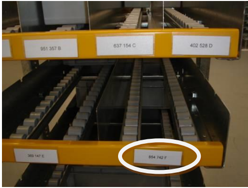
Porte étiquette pour identifier chaque couloir
