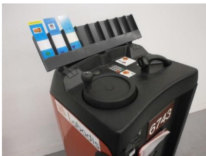
Possibilité d'adapter un pupitre pour ranger les cartes Kanban de prélèvement
