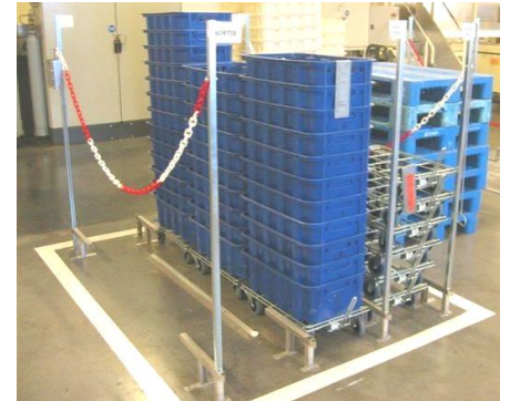
Module de stockage en inox (L0084) ilôtés avec des bandes au sol et avec des chaînes plastique
