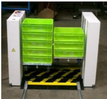
Le dépileur fonctionne avec toutes les hauteurs de bacs (maximum 320). L'ajustement se fait par une vis réglable à la main
