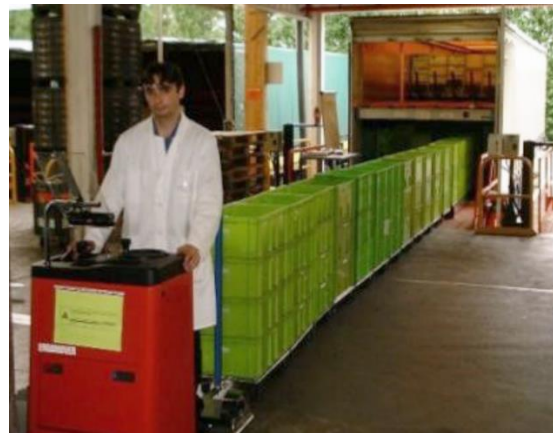
Déchargement de 22 Rollis en une fois
