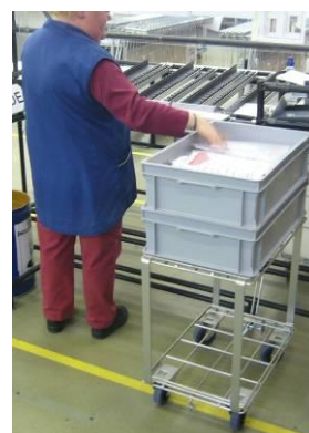
Prise dans la fenêtre ergonomique sur un Rollis rehaussé
