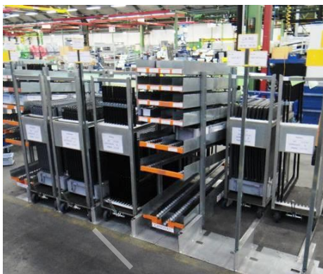
Bord de ligne de montage mixé : Rollis et bacs en Rack
