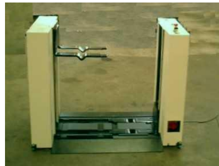
Le dépileur est traversant, on peut aller chercher le Rollis® suivant
