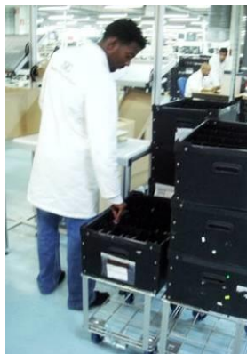
Approvisionnement des bacs en pas carré ; l'opérateur ne se baisse plus
