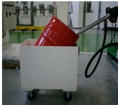
Un système permet d'incliner le fût pour le vider complètement
