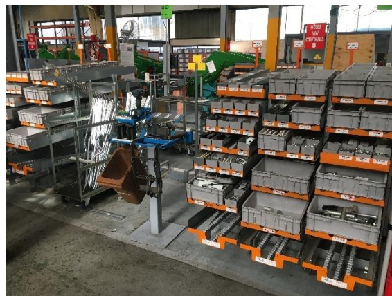
Chaque Rack est modulé selon le type d'emballage. La prise des pièces est compacte et limite le déplacement de l'opérateur
