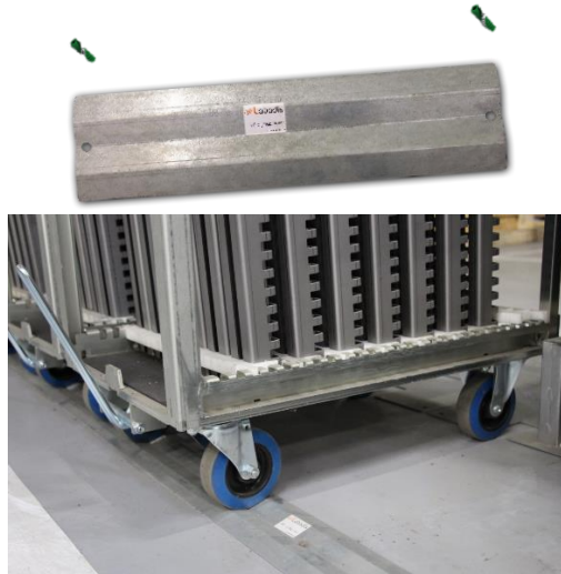
Le positionneur bloque les 2 roues avant
