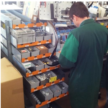
Prise ergonomique des pièces grâce au décalage des nappes en clavier d'orgue
