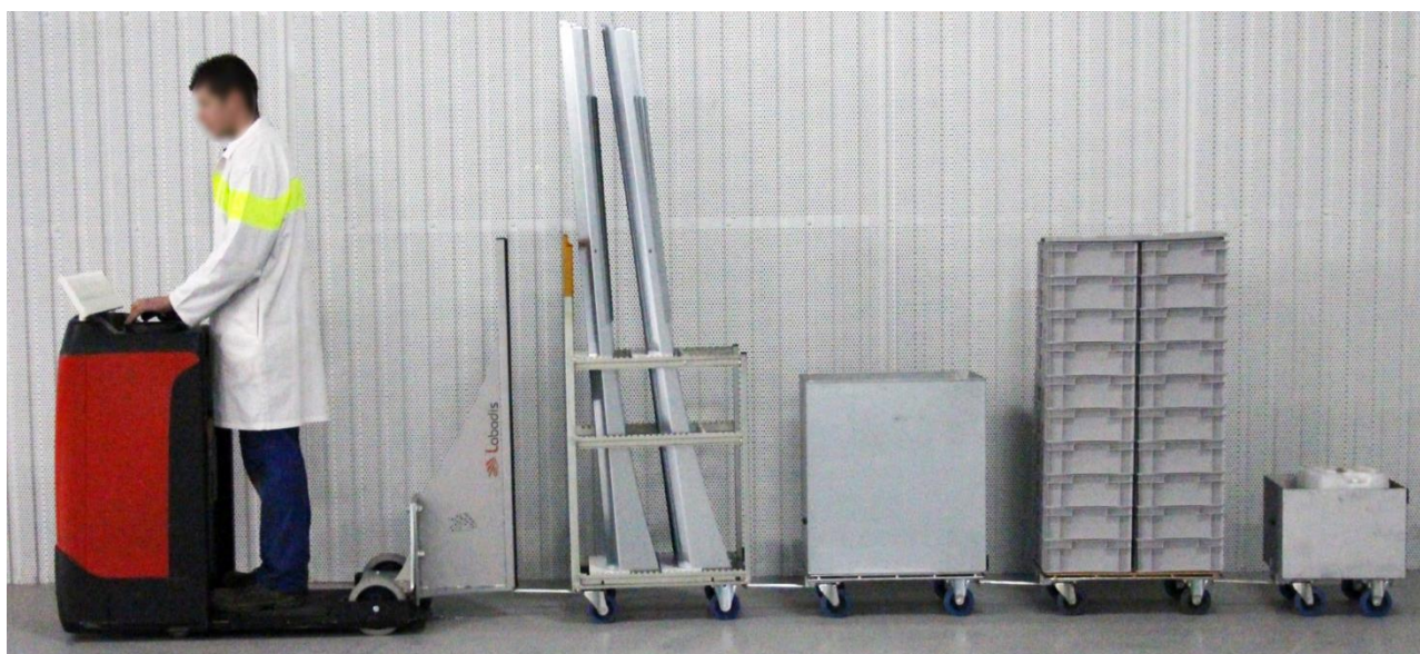
Train de Rollis® avec la locomotive Ergomover et son arceau de traction
