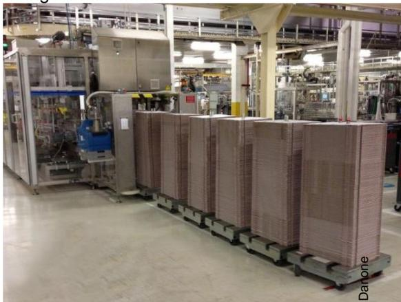
Hotdog-Rollis werden automatisch in eine Faltmaschine für Kartons gefahren.
