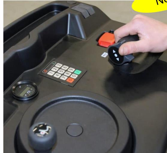
Gaspedal auf der Bedienungsstafel, um die Füße auf der Maschine stabil zu halten
