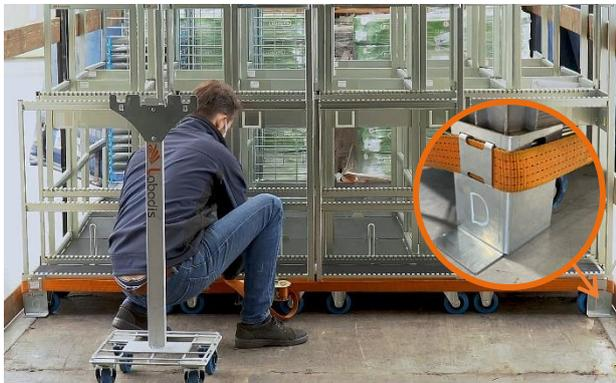
Immobilisierung der Rollis durch einen Gurt (L0605), der an der Karosserie eines Standard-LKW aufgehängt ist. Der Träger (L0628)
