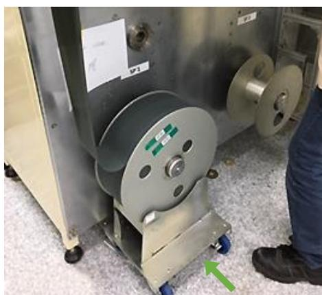
Seitliches Laden einer Spule auf eine Spindel
