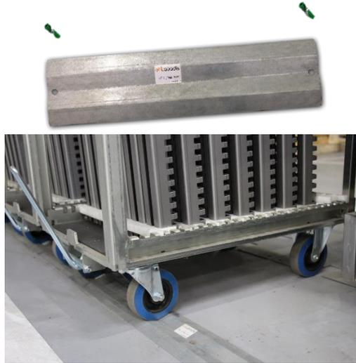
Der Positionierer blockiert die beiden Vorderräder
