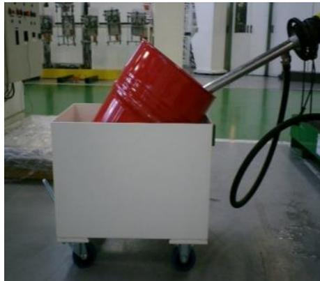
Ein System ermöglicht das Fass zu kippen um es vollständig zu leeren.
