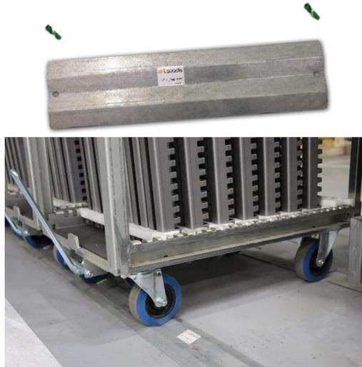
Le positionneur bloque les 2 roues avant
