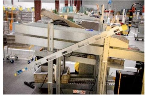
**NB :** La pente dépend de la propreté du rail et de la géométrie et rigidité des cartes. Les cartes plastifiées finissent par se corner et se bloquent dans les goulottes. Nous recommandons les [cartes imprimées](#).
