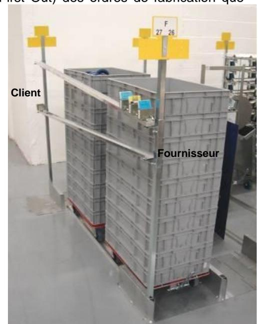
Rail de lancement (**L0196**) fixé par 2 pattes (**L0195**) sur les poteaux des modules de stockage
