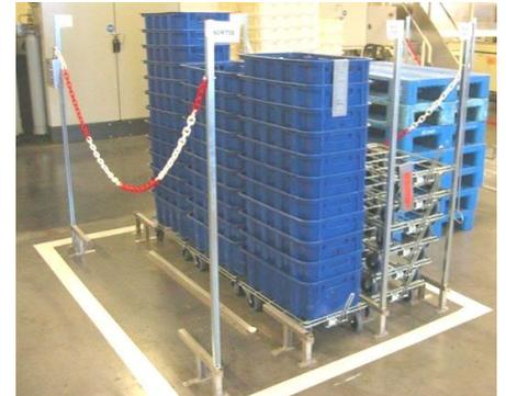
Module de stockage en inox (L0084) ilotés avec des bandes au sol et avec des chaînes plastique
