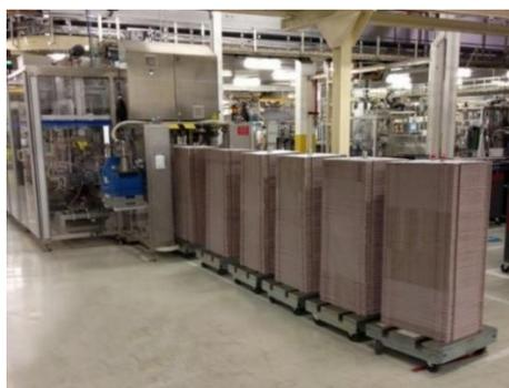
Rollis rentrant automatiquement dans une plieuse de carton
