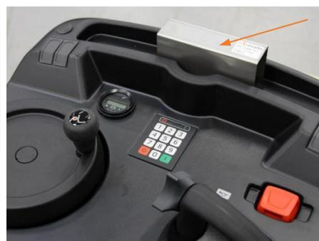
Cavalier rangé sur le tableau de conduite de la locomotive Ergomover
