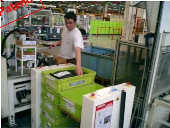
Greifen der Teile in optimaler Höhe
