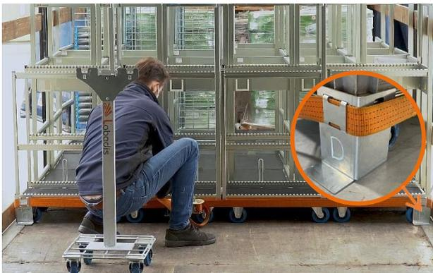
Immobilisierung der Rollis durch einen Gurt (L0605), der an der Karosserie eines Standard-LKW aufgehängt ist. Der Träger (L0628)
