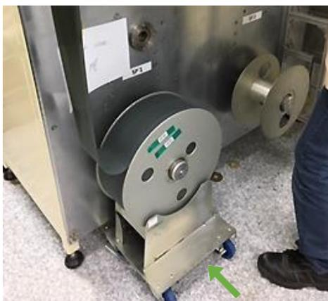
Seitliches Laden einer Spule auf eine Spindel
