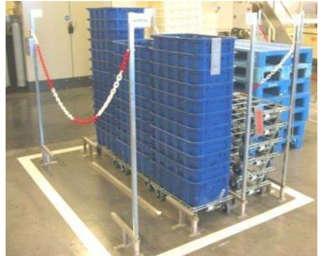
Lagermodul aus Edelstahl (L0084) zoniert mit Klebebändern und Kunststoffketten
