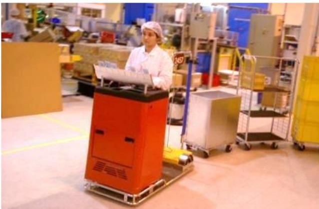
Der Kanban Pult wird in den oberen Löchern des Ergomover befestigt. Kein Anpassungsbedarf
