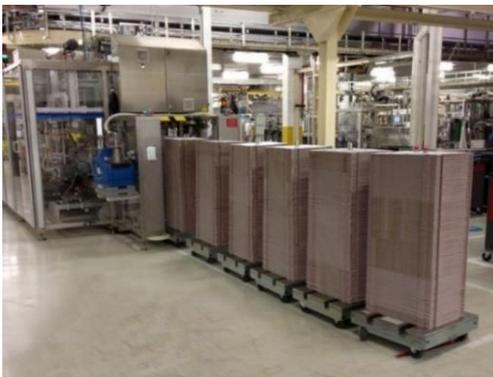
Hotdog-Rollis werden automatisch in eine Falmaschine für Kartons gefahren.
