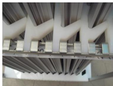
Edelstahl-Achse (**L0069**), die in die Zahnstange eingesetzt ist und die Trennhalter durchquert.
