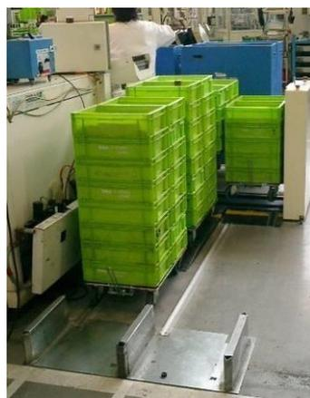
Ein-und-Aus Bausatz um eine Stapelhebeemaschine zu versorgen
