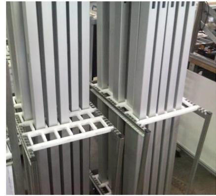
Die Trennhalter halten die Teile. Sie werden auf die nummerierten Zahnstangen gesteckt.
