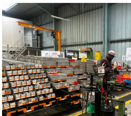
Chaque Rack est modulé selon le type d'emballage. La prise des pièces est compacte et limite le déplacement de l'opérateur (Ribouleau Monosem)
