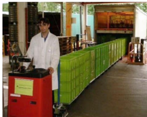
Déchargement de 22 Rollis® en une fois
