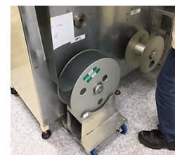
Chargement latéral d'une bobine sur broche (Linxens)
