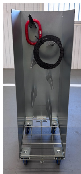
Configuration avec broches pour composants suspendus
