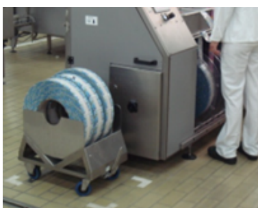
Le Rollis® bobine U peut accueillir plusieurs bobines grâce à des compartiments (Danone)
