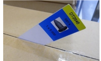
La carte peut s'insérer directement dans les rainures du carton pour identifier son contenu. L'information sur la carte Kanban est toujours visible.
