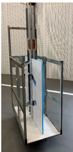
Les pièces sont maintenues sans déformation par les bras latéraux (Atlantic Netherland).
