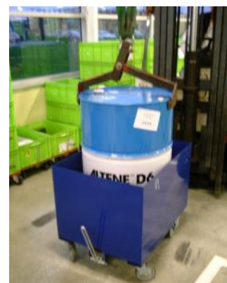
Le chargement se fait par pince avec palan ou chariot à fourche
