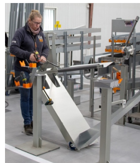
Le pied de posoir peut également servir de support d'outils
