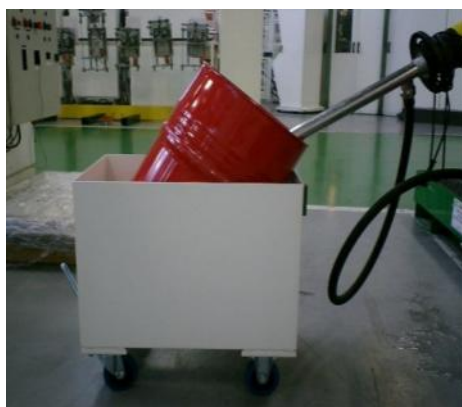
Un système permet d'incliner le fût pour le vider complètement
