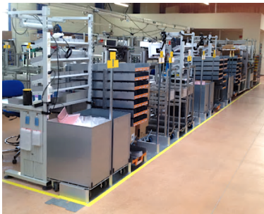
La ligne alterne poste et approvisionnement en bac dans un Rack et pile sur Rollis® (Bio Rad)
