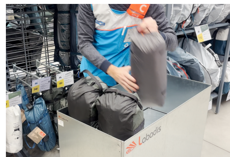
Plateau remonte au fur et à mesure du déchargement pour une mise à hauteur constante (Decathlon)
