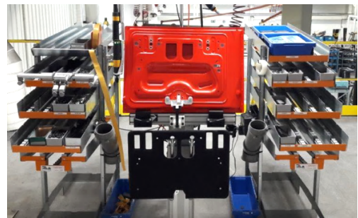
28 pièces sont amenées dans la zone de prise de l'opérateur (Volvo)
