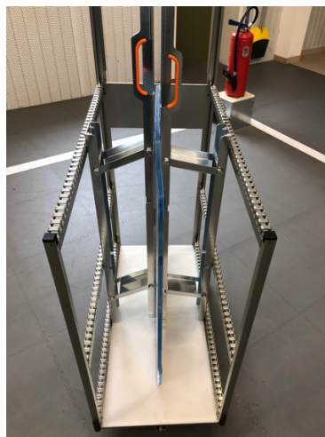
La pression exercée par les bras permet de tenir différentes épaisseurs ou un nombre variable de pièces.
