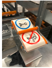
Nappe dévidoir avec pelage, prise directe de l'étiquette
