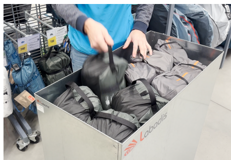
Plateau remonte au fur et à mesure du déchargement pour une mise à hauteur constante (Decathlon)
