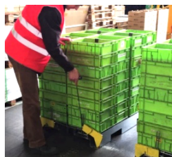
Les chariots Rollis® sont sortis attelés avec à la gaffe de traction (L0005).
