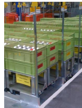
Stockage à plat de Rollis® Poney lesté pour pôles de disjoncteur en cuivre
