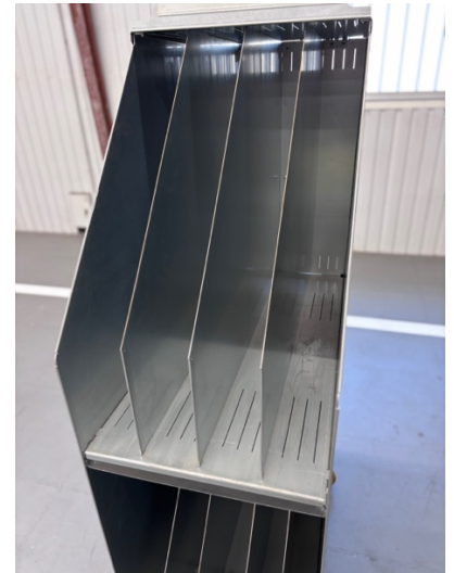
Le pas de 25 mm permet d'ajuster la position des intercalaires selon le kit.
