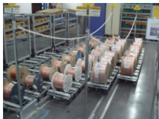
Stockage à plat FIFO des bobines
