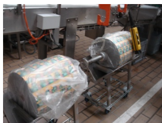
Insertion de l'axe support à hauteur d'homme (Danone)
