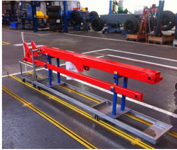
Rollis® transatlantic de 2 400 mm utilisé comme navette pour le transport de poutres
