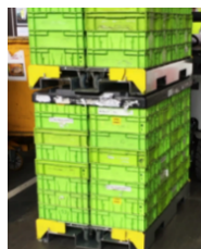
Gerbage de 2 palettes à Rollis® avec une coiffe
