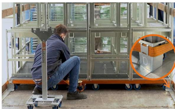
Immobilisation des chariots par une sangle Rollis® (L0605) accrochée à la caisse d'un camion standard
