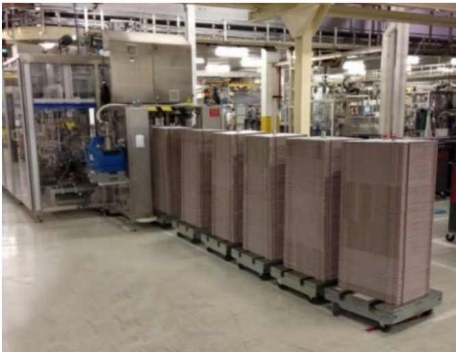
Rollis® rentrant automatiquement dans une plieuse de carton (Danone)
