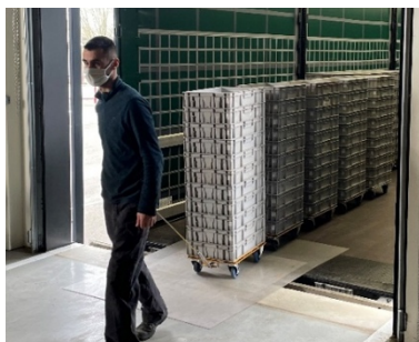
Une plaque de polycarbonate entre le quai et la remorque permet le chargement et le déchargement des Rollis®
