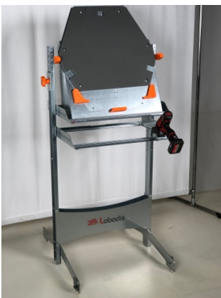
Support d'assemblage compact pour sous ensemble directement dans la ligne (Aldes)
