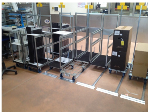
La profondeur des couloirs est déterminée selon la fréquence d'approvisionnement.
