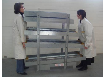
La structure autoporteuse permet de déplacer le rack à la main au lieu même de consommation sur la ligne
