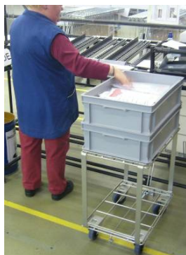
Prise dans la fenêtre ergonomique sur un Rollis® réhaussé
