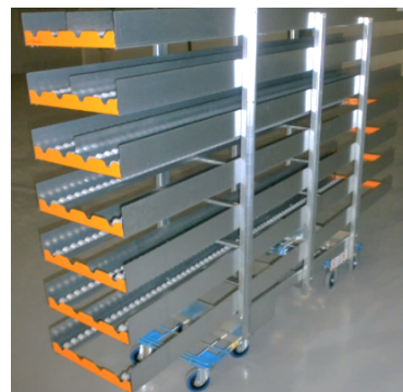
Patinette (LD0584) pour déplacer les racks. Les 4 roues pivotantes permettent le déplacement latéral.
