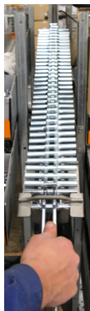
Approvisionnement au poste d'une pièce à la fois (Minomi) avec retournement Karakuri
