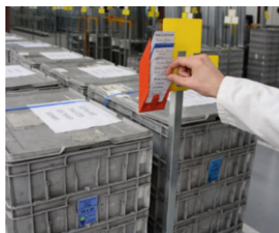
Boîte à lot mise sur le poteau du module de stockage
