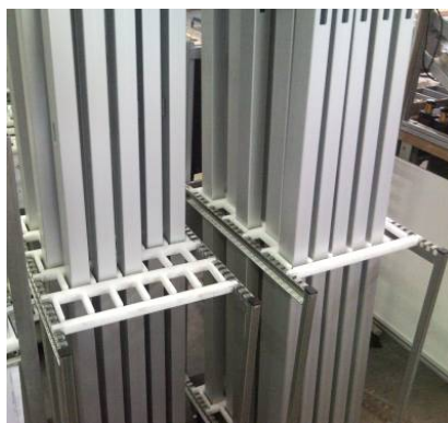
Le séparateur maintient les pièces ; il se positionne sur une crémaillère numérotée
