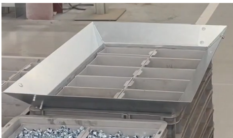
L'entonnoir (L0670) pour bac 400x600 mm permet de reconditionner les pièces en quelques secondes dans tous types de mini bacs.
