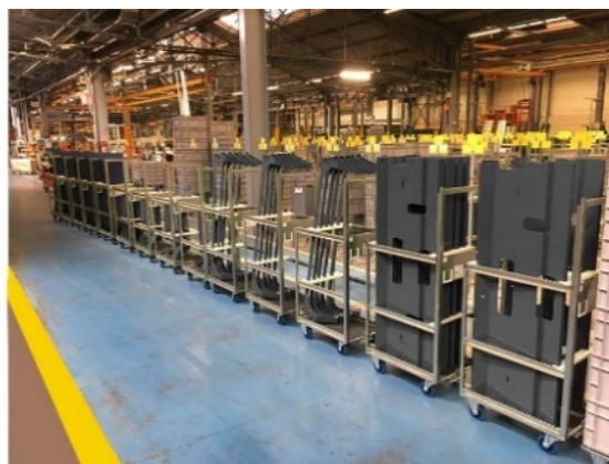
Les Rollis® en fonctionnement petit train pour mutualiser les transferts (John Deere).
