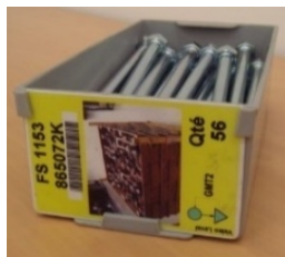
La carte Kanban (format carte de crédit) est logée dans des encoches moulées dans la masse ; sa prise est facile et sans hésitation grâce à son inclinaison
