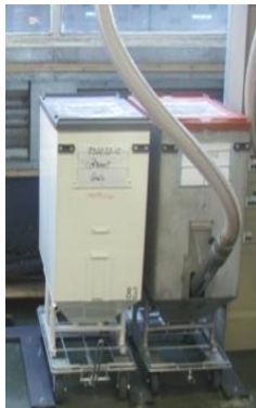
La faible taille du Rollis® permet de mettre plusieurs nuances, au plus près de la presse à injecter
