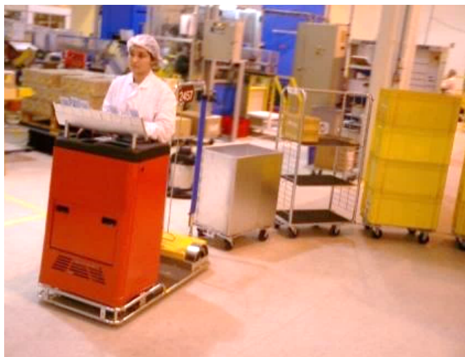
Le pupitre de Kanban se fixe dans les trous supérieurs de l'Ergomover. Pas besoin d'adaptation
