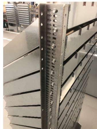
Réglage par pas de 10 mm.
