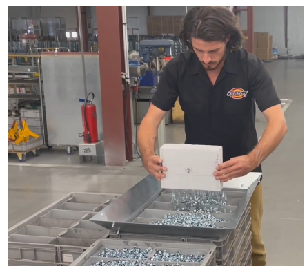
L'entonnoir (L0670) pour bac 400x600 mm permet de reconditionner les pièces en quelques secondes dans tous types de mini bacs.
