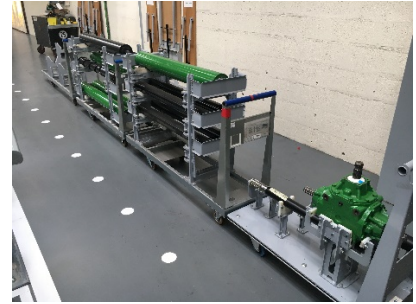
Largeur standard pour le transfert en petit train (John Deere)
