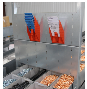
Support pour boîtes à lot sur Rack de stockage (L0542)
