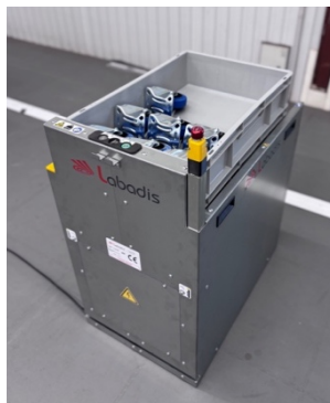
Une goulotte permet de noyer le câble d'alimentation dans la paroi de l'élévateur et de le faire sortir à droite ou à gauche
