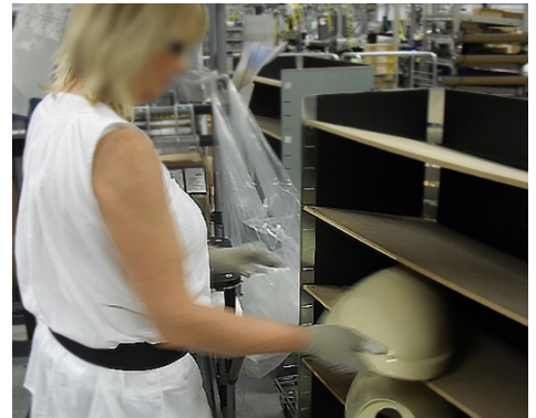
Option Akilux protège latéralement les pièces déposées sur les étagères.
