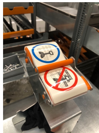
Dévidoir qui décolle directement l'autocollant pour simplifier la prise par l'opérateur.
