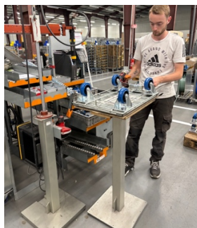
L'ajout de plaques de lest assure la stabilité du posoir
