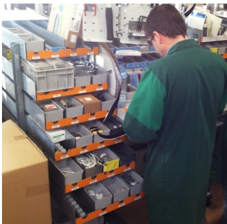
Prise ergonomique des pièces grâce au décalage des nappes en clavier d'orgue (Bio Rad)
