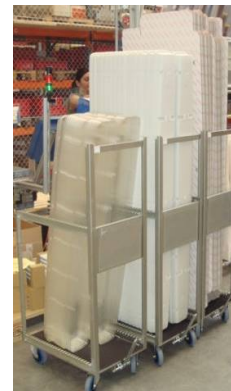
Le tapis caoutchouté permet d'absorber les secousses pour le transport de pièces fragiles
