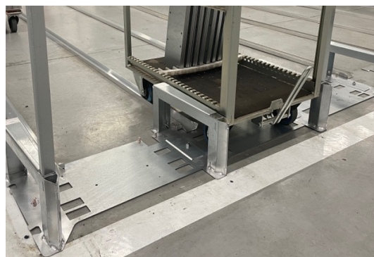
Le module permet d'introduire le Rollis® directement dans le rail, sans avoir à viser.
