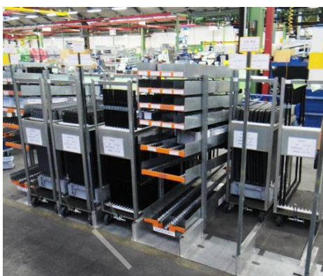
Bord de ligne de montage mixé : Rollis® et bacs en Rack (Same Deutz Fahr)
