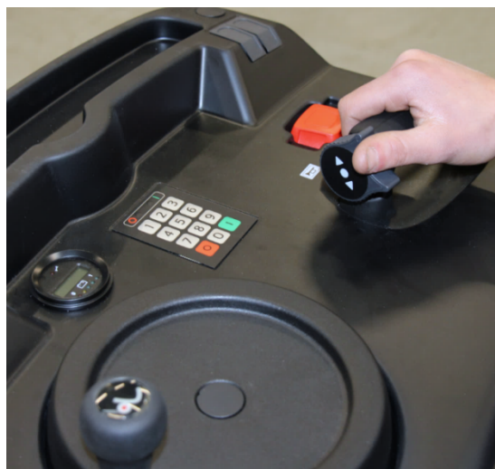
Accélérateur au niveau du tableau de conduite, pour garder les pieds stables sur la machine
