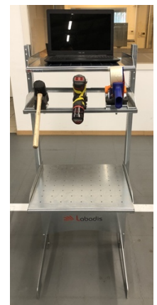
Outils et ordinateur sur un même support pour densifier le bord de ligne.
