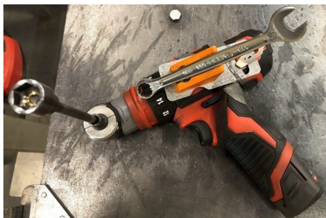
Visseuse avec clé embarquée : Ergonomique, on ne cherche plus la clé, elle est là quand on en a besoin.
