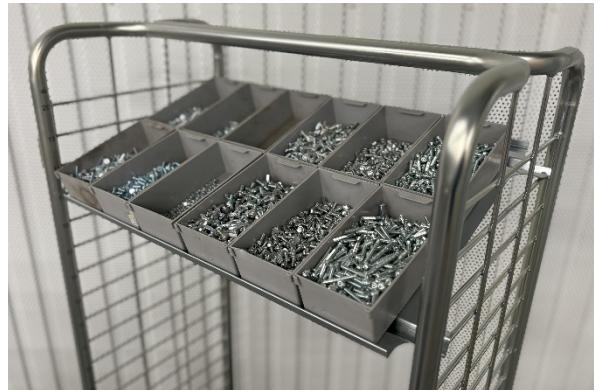
Étagère inclinée (L0526) pour une prise direct par l'opérateur sur la ligne (avec une servante Track & Slide)
