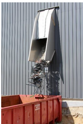
Le Vidatris est traversant et permet de vider les déchets dans la benne sans sortir du bâtiment
