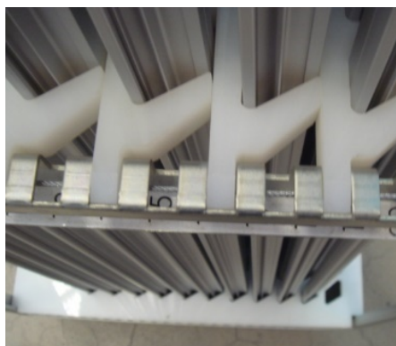
Axe en inox (L0069) inséré dans la crémaillère et traversant les séparateurs
