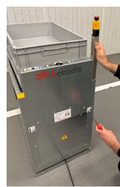
Hauteur de prise réglable Arrêt d'urgence accessible de partout Cable positionnable sur les 3 faces
